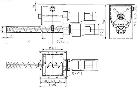
Abmessungen Standardausstattung Dosiergerät DSR-25-T mit trogbodenförmigem Behälter
