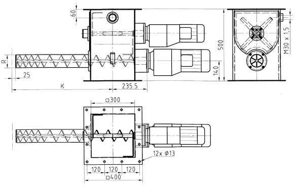
Abmessungen Standardausstattung Dosiergerät DSR-25-Q mit quaderförmigem Behälter ohne Boden
